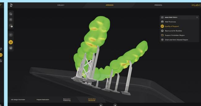
Zur Qualitätsverbesserung zeigt die Software die Einhaltung bzw. Nichteinhaltung der vom Hersteller vorgeschriebenen Wandstärke an – ein besonderer Vorteil des Validierungsprozesses, der für jedes Primeprint Material durchgeführt wurde. So können zusätzliche Korrekturen vorgenommen werden, wenn zum Beispiel Nichtkonformität festgestellt wird.
