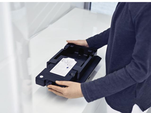
**X** Die Materialeinheit ist UV-Licht geschützt. Dies bedeutet, dass das verbleibende Harz bis zur nächsten Verwendung in der Materialeinheit verbleiben kann. Die geschlossene Kartusche verhindert, dass Haut und Gerät mit dem flüssigen Druckharz in Berührung kommen.
