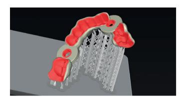
Primeprintソリューションによる3Dプリントでは、 CAMソフトウェアのアルゴリズムがCERECおよび inLab CADソフトウェアで付与された特定の歯科情報を検出し、 適用することでプリントジョブを最適化します。
