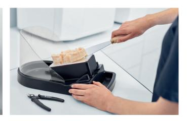
完成したプリントオブジェクトはサポート構造により ビルドプラットフォームから簡単に素早く取り外すことができます。 プラットフォームホルダーは、 より取り外しがしやすいように特別に設計されています。
