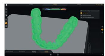
Primeprintの各マテリアルは、検証プロセスが実施されているため、マテリアルメーカー規定の厚みの強度に適合しているかを表示。 症例で厚みを満たしていない場合は、修正を加えることができます。
