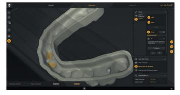
後の洗浄プロセスで空気が閉じ込められたり、 レジンのプディングができたりする可能性があり、 洗浄が不十分となり得る箇所を表示。 CAMソフトウェア内でバーチャルでポジショニング、 設計工程に戻る必要がありません。
