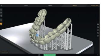
プリンティングプロセスが即座に開始され、時間が節約され、マニュアルでの追加調整が不要です。 あるいは、ユーザーはCAMソフトウェアでガイダンスに従い 段階的に特定のプリントオブジェクトを作成し、 お好みのさまざまな調整オプションもご利用いただけます。
