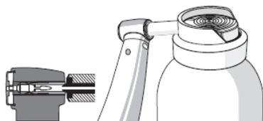
5. Fiber optic cable surface를 세척할 때는 Surface(A)의 먼지를 공기로 털어내고 Q-Tip 또는 부드러운 천등으로 표면을 닦는다.
