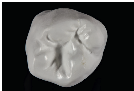
Предварительно отполированная коронка перед синтеризацией
