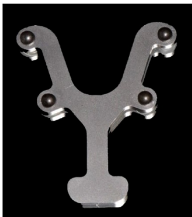
Рисунок 1. Металлический эталон с четырьмя стальными сферами.
